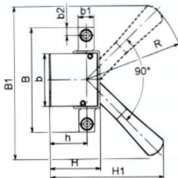
Рис. 2. Выключатель-разъединитель на одно направление трехполюсный с боковой рукояткой
